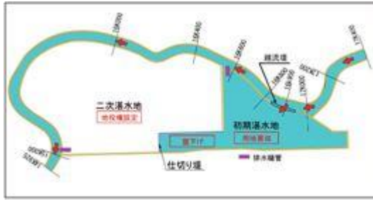
図-4 W=1/10 洪水時の遊水地湛水状況
