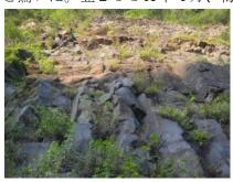
立野ダム本体予定地右岸(北側)を見上げた写真 立野溶岩と不連続面が6つ以上確認された 2011 年 10 月 10 日撮影
