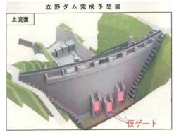
立野ダム完成後、仮ゲートで穴をふさぎ 試験湛水(試験的に水を貯める)を行う (国土交通省資料より)
